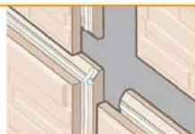
上下2方向の突<sup>ツバ</sup>だけだと左右接合部はシーリング接合となります。四方合いじゃくり品は4方向に突<sup>ツバ</sup>があるため、シーリング目地が大幅に減り、外壁がより自然に仕上がります。
