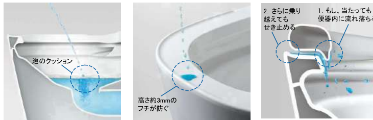
泡のクッションで受け止める「ハネガード」(リモコン式) フチの立ち上がりで、外に垂れ出しにくい「タレガード」。 便座と便器の合わせ技でせき止める「モレガード」。
