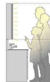
両サイドからの均一な光で、背の高 さに関係なく、顔全体を明るく照ら します。
